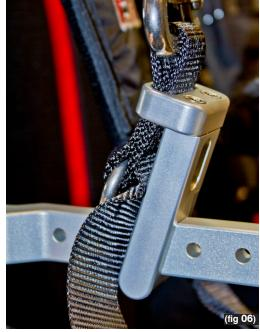
REMEMBER THAT NOW THE **BALANCING** POINT IS THE **TOP PART** OF THE ATS WHERE THE **PARAGLIDERS ATTACHMENT LOOP GOES** THROUGH, **SO MOVING** THE SHACKLE HAS NO **INFLUENCE IN** YOUR POSITION **DURING FLIGHT.**
