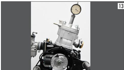
A valore raggiunto, con una mano tenere fermo la puleggia o l'albero motore nella parte opposta e con una chiave bloccare il dado del volano, ma senza eccedere. Riverificare che l'anticipo sia nei valori segnalati ( $3,7 \pm 0,1$ ) togliere la vite m.5x30 e montare la bobina. Prima di bloccarla con le due viti interporre fra bobina e volano uno spessore calibrato da 0,35 mm (foto 14).
