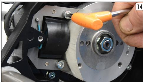
Procedere al bloccaggio definitivo del dado volano utilizzando una chiave dinamometrica a 40 Nm. (foto 15).
