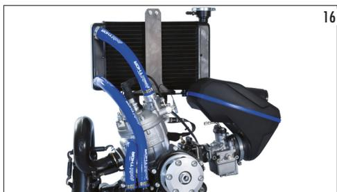
Tagliare a misura i tubi dell'acqua e montarli. Chiudere le fascette in dotazione utilizzando una pinza apposita per il montaggio (foto 17).
