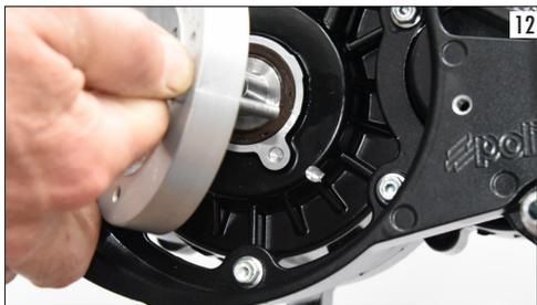
Avvitare il dado del volano senza bloccarlo in modo tale che l'albero motore possa girare nel volano. Avvitare nel foro della candela il supporto del comparatore, posizionare il comparatore e portare il pistone al punto morto superiore. Azzerare il comparatore e ruotare l'albero motore in senso antiorario di 3,7 mm guardando dal lato volano (vedi freccia foto 13).
