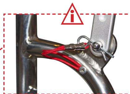
NO OLVIDAR PONER EL CLIP DE SEGURIDAD DE LA BARRA DE REFUERZO.
