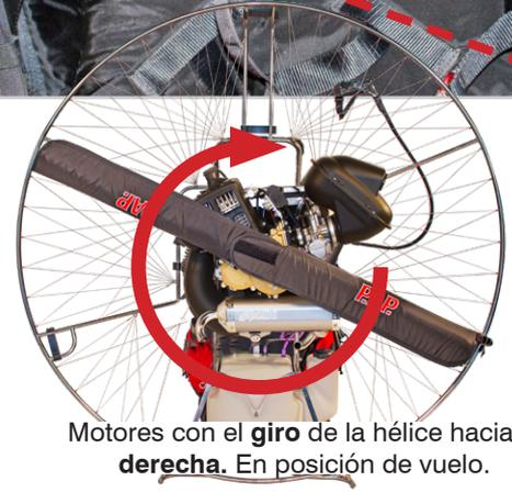
Motores con el **giro** de la hélice hacia la **derecha**. En posición de vuelo.
