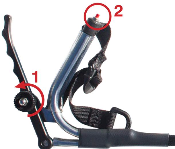
Antes de arrancar es necesario comprobar que la palanca de gas retorna correctamente y que la ruleta del bloqueo del gas esté aflojada (1). Para aflojarla giraremos completamente la rueda en sentido antihorario hasta llegar a su tope, como muestra la imagen.
