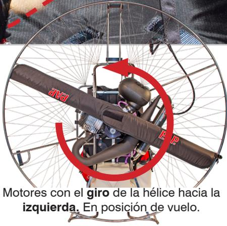
Motores con el **giro** de la hélice hacia la **izquierda**. En posición de vuelo.
