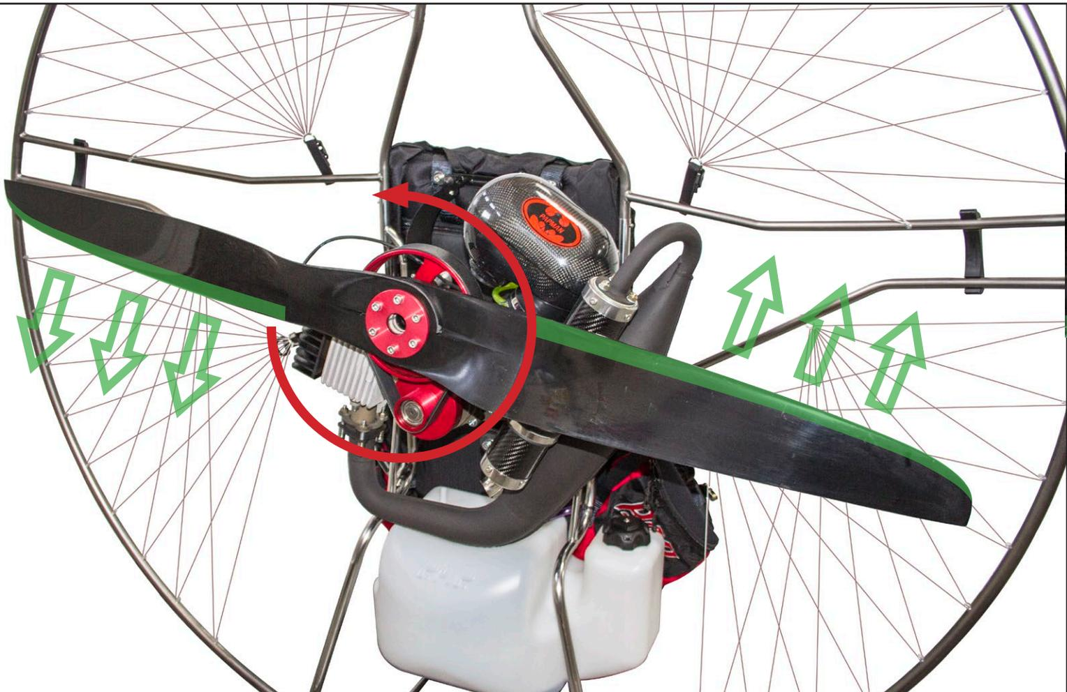
Motores con el **giro** de la hélice hacia la **izquierda**. En posición de vuelo.
