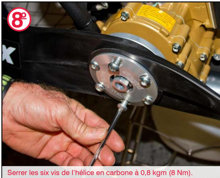
Serrer les six vis de l'hélice en carbone à 0,8 kgm (8 Nm).
