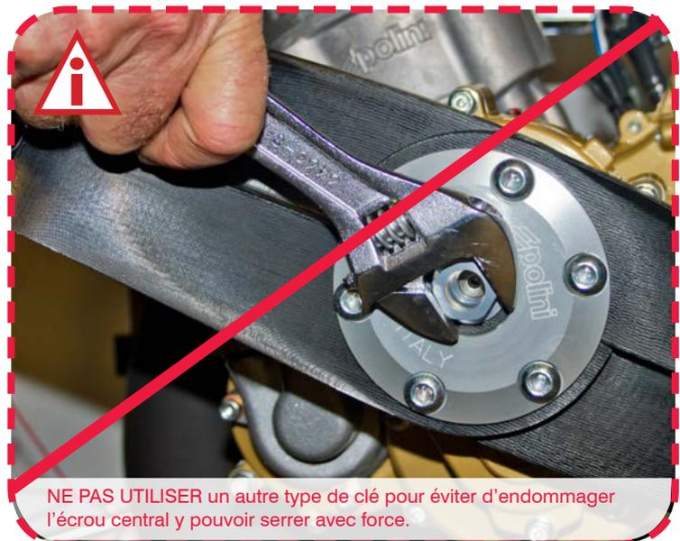
**NE PAS UTILISER** un autre type de clé pour éviter d'endommager l'écrou central y pouvoir serrer avec force.
