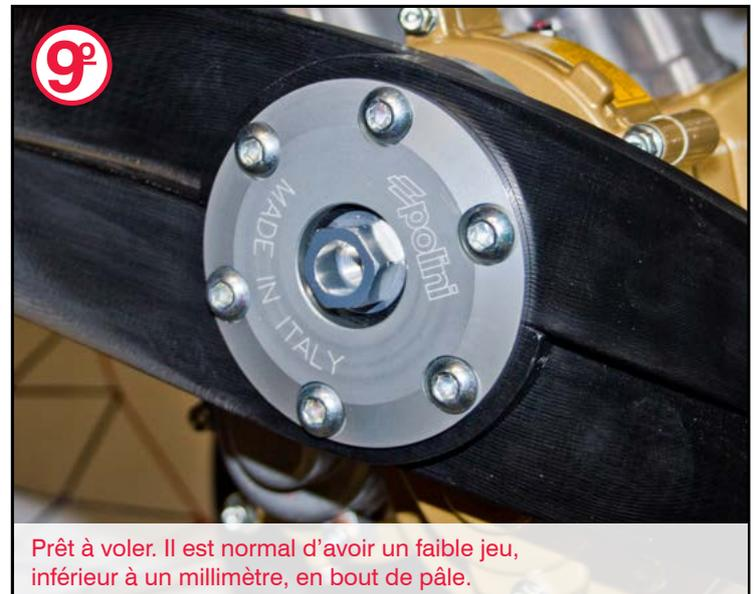
Prêt à voler. Il est normal d'avoir un faible jeu, inférieur à un millimètre, en bout de pale.
