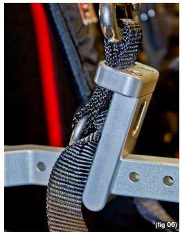
Í١ REMEMBER THAT NOW THE BALANCING POINT IS THE **TOP PART** OF THE ATS WHERE THE PARAGLIDERS **ATTACHMENT** LOOP GOES THROUGH, SO MOVING THE SHACKLE HAS NO **INFLUENCE IN** YOUR POSITION DURING FLIGHT.
