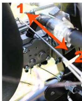
::: N. 25B ::: ::: CARB. WALBRO: MANDO DE AIRE ::: ::: WALBRO CARB: CHOKE :::
