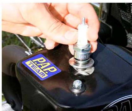
::: N. 28 ::: ::: BUJIA: ARANDELA DE SEPARACION ::: ::: SPARK PLUG: SEPARATION RING :::
