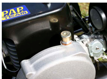
::: N. 23 ::: ::: REDUCTORA: VALVULA DE SEGURIDAD ::: ::: REDUCTOR GEAR: SAFETY VALVE :::
