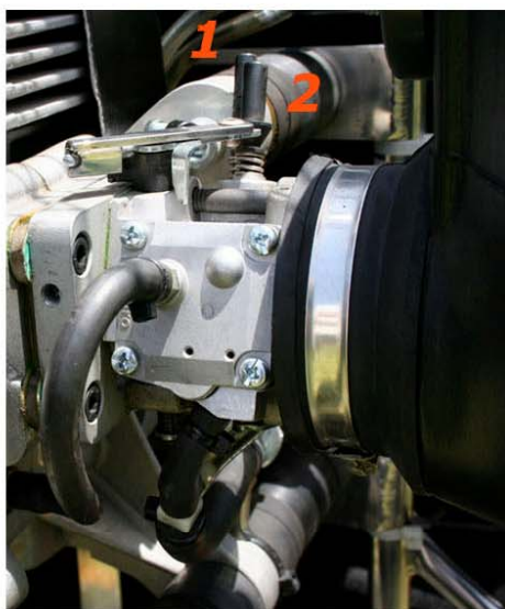
::: N. 26 ::: ::: CARBURADOR WALBRO 24 ::: ::: WALBRO 24 CARBURETTOR :::
