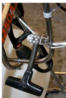
17F ::: N. 17F ::: ::: SISTEMA ARRANQUE ::: ::: START SYSTEM :::
