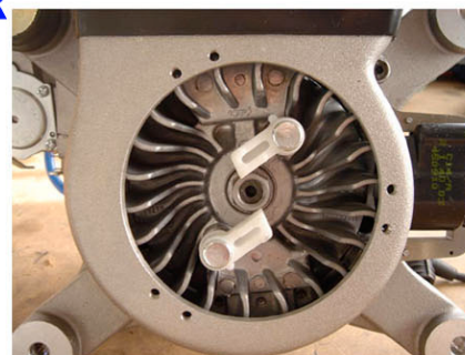
!!! N. 23 !!! !!! SISTEMA DE ARRANQUE !!! !!! START-UP SYSTEM !!!
