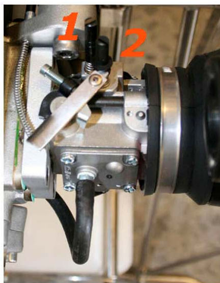
::: N. 26B ::: ::: CARBURADOR WALBRO 24 ::: ::: WALBRO 24 CARBURETTOR :::
